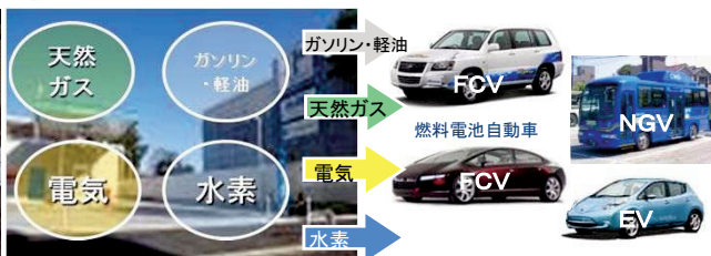
水素・電気・天然ガス等の多様なエネルギーを災害時に供給可能なハイパーエネルギーステーション
